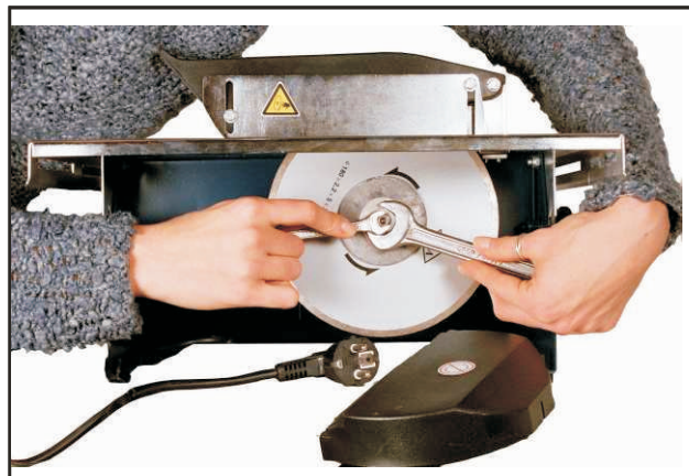
OBR. 6. Způsob demontáže řezného kotouče
